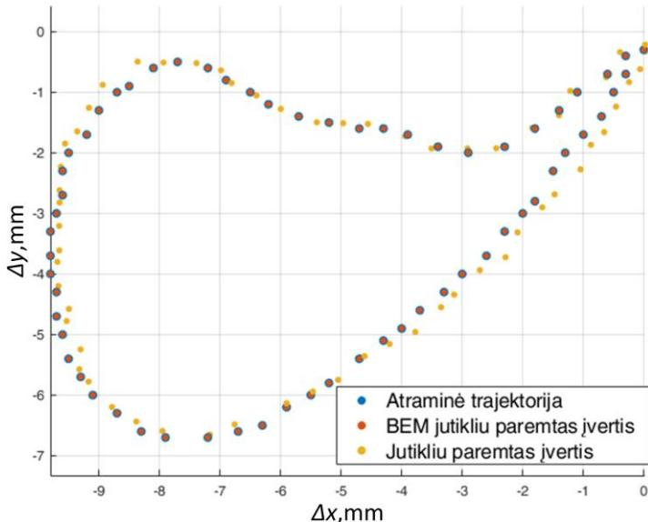
**4.8 pav.** Bandomoji trajektorija, nustatyta dvejų magnetometrų metodu su FML kompensavimu. Su teoriniais BEM duomenimis  $VKP = 0,05 \text{ mm}$  (raudona), o su eksperimentiniaisiais „Elinta“ trimačio (3D) pozicionavimo sistema užfiksuotais duomenimis  $VKP = 0,28 \text{ mm}$  (geltona)
