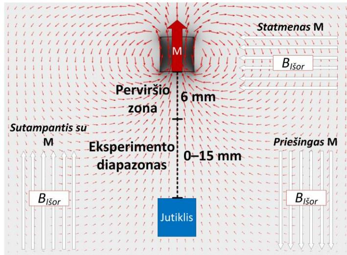
**3.6 pav.** Įvairiomis kryptimis simuliuko FML esant įvairiems atstumams tarp magneto ir jutiklio salygotų paklaidų tyrimo schema. Tyrimas atliktas su teoriniais ir kompensuotais eksperimentiniai duomenimis
