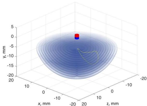
**3.17 pav.** Darbinė erdvė, padalyta į skirtinį atstumą (iki magneto) zonas.
