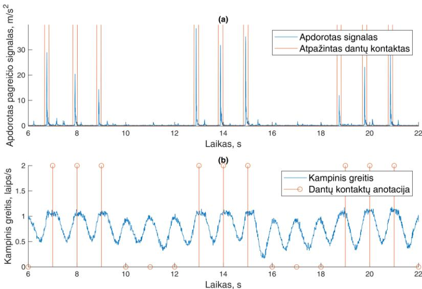
**4.5 pav.** Dantų kontaktų (susitrenkimų) atpažinimas vertikaliame judesuje:
