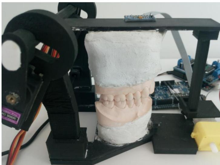
**3.4 pav.** Vertikalaus žandikaulio jadesio artikulatorius su pritvirtinta inercinių matavimų sistemos (IMS) plėtojimo plokštė
