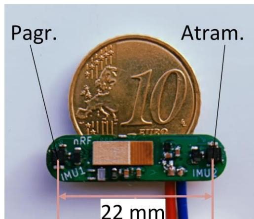
**3.12 pav.** Belaidžio dviejų magnetometrų jutiklio prototipas
