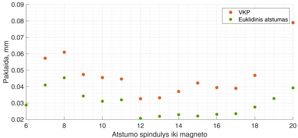
**4.12 pav.** Dviejų magnetometrų lokalizacijos su FML kompensavimu taikant MK optimizavimą BEM tyrimas. Vidutinės kvadratinės paklaidos (VKP) ir vidutinio Euklidinio atstumo (EA) iki tikrosios jutiklio trajektorijos priklausomybė nuo atstumo spindulio iki magneto
