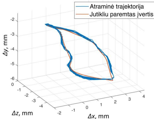
**4.20 pav.** Magnetiniu jutikliu paremtas kramtymo kreivės įvertis, užregistruotas robotizuoto artikulatoriaus bandymo metu. Atraminė trajektorija užregistruota sistema „TrakStar“
