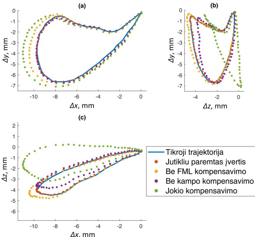
**4.23 pav.** 5-LL bandomoji kramtymo kreivė, įvertinta be FML kompensavimo bei žandikaulio pasisukimo kampo vertinimo algoritmuli ir su jais. Magnetinio lauko vertės kiekviename taške užrašytos jutikliui nejudant: (a) šoninis–vertikalus vaizdas ( $x-y$ ); (b) prikinis–vertikalus vaizdas ( $z-y$ ); (c) šoninis–prikinis vaizdas ( $x-z$ )
