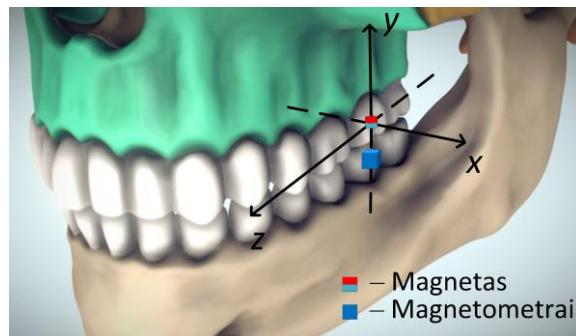
**3.2 pav.** Žandikaulio pozicijos sekimo vienu magnetometru konceptas
