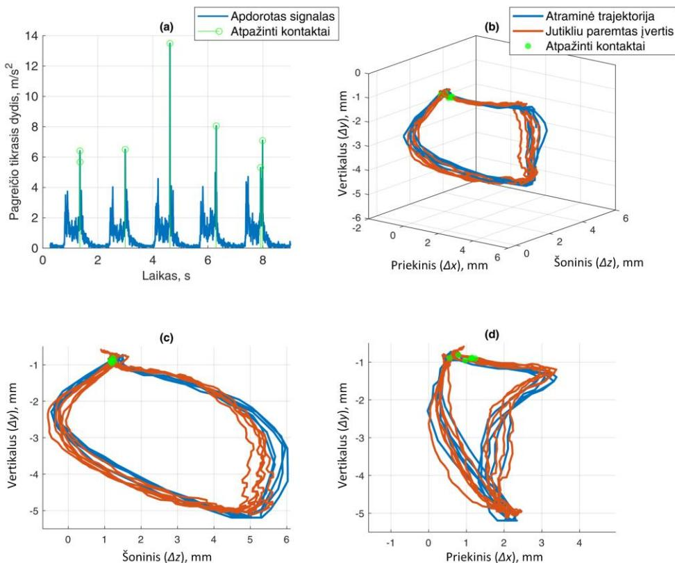
**4.6 pav.** (a) Dantų kontaktai, atpažinti pagreičio vektoriaus tikrojo dydžio signale su  $5 \text{ m/s}^2$  aptikimo slenkščiu. (b) Bandomoji trajektorija, nustatyta atraminiu metodu ir magnetiniu lokalizacijos metodu, paryškintos pozicijos, ties kuriomis
