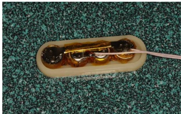
**3.13 pav.** Pagamintas 3,1 V, 64 mAh baterijų paketas
