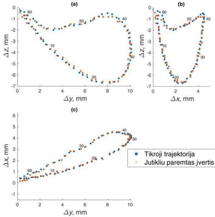
**4.3 pav.** Bandomosios kramtymo trajektorijos pozicijos, apskaičiuotos iš magnetinio lauko verčių, užregistruotų vienu magnetometru. Išmatuotos koordinatės sunumeruotos nuo 0 iki 62, ir 10 matavimo iteracijų pavaizduotos skaidriomis raudonomis žymėmis: (a) šoninis–vertikalus vaizdas ( $y$ – $z$ ); (b) priekinis–vertikalus vaizdas ( $x$ – $z$ ); (c) šoninis–priekinis vaizdas ( $y$ – $x$ )
