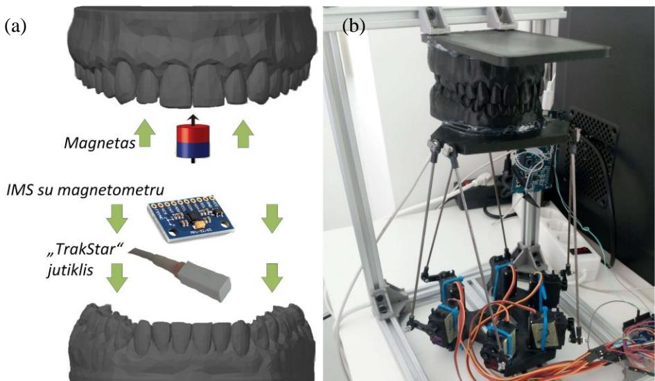
**3.5 pav.** Eksperimento schema dinaminiam lokalizacijos tyrimui su dinaminiu okliuzijos nustatymu (a), panaudojant Stiuarto platformą (b)
