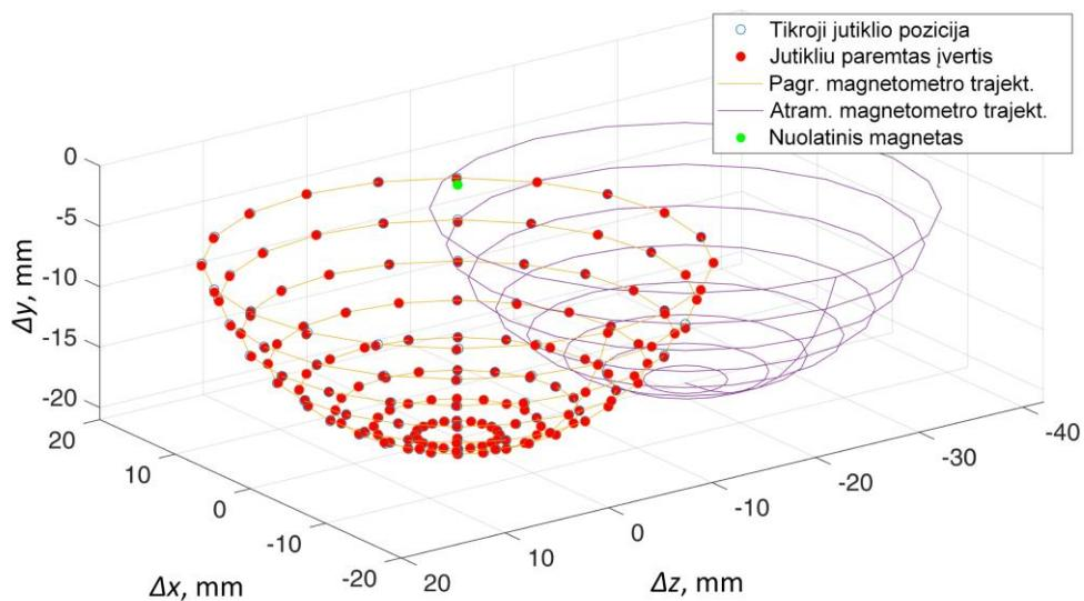
**4.11 pav.** Dviejų magnetometrų lokalizacijos su FML kompensavimu matavimas BEM aplinkoje, ties  $R = 20 \text{ mm}$  radialiniu atstumu nuo magneto
