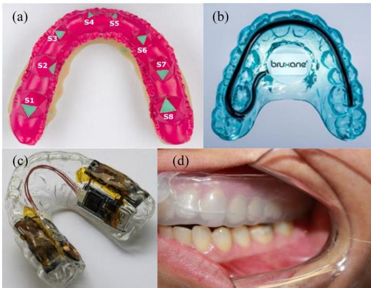
**1.2 pav.** Okliuzinės kapos bruksizmo diagnostikai: (a) nusitrinančios kapos pusiau automatiniam vertinimui skanuoojant [24]; (b) „Bruxane“ kapos su integruotais slėgio jutikliais [25]; (c) kapa su integruotais pjezorezistiniais slėgio jutikliais [5]; (d) kapa su optinio pluošto slėgio jutikliais [26]
