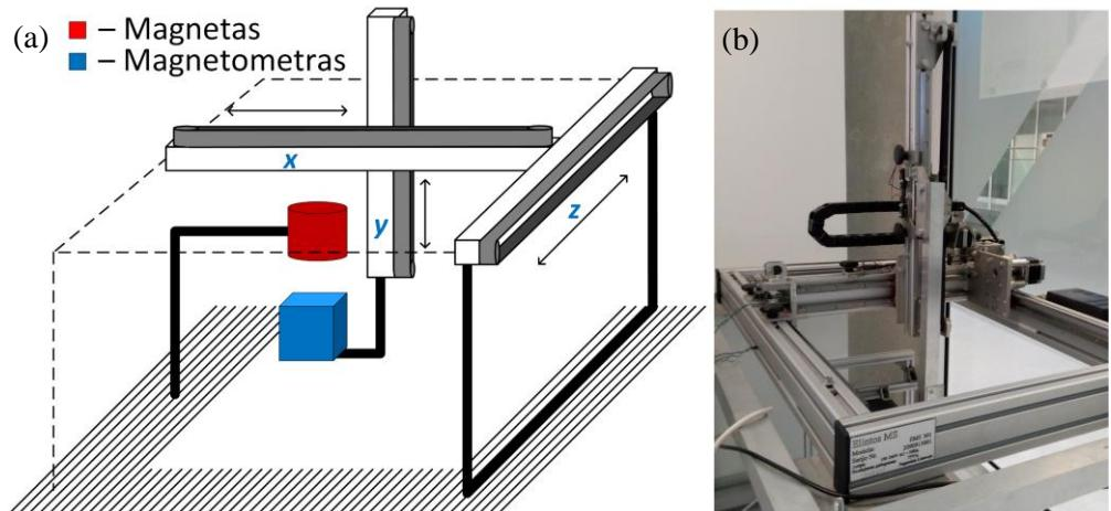
**3.3 pav.** Eksperimento schema (a), ir trimačio (3D) pozicionavimo sistema „EMS 301“ (b)
