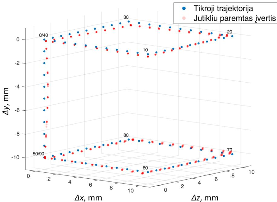
**4.1 pav.** Kubinės bandomosios trajektorijos pozicijos, apskaičiuotos iš magnetinio lauko verčių, užregistruotų vienu magnetometru. Išmatuotos koordinatės sunumeruotos nuo 0 iki 90, ir 10 matavimo iteracijų pavaizduotos skaidriomis raudonomis žymėmis
