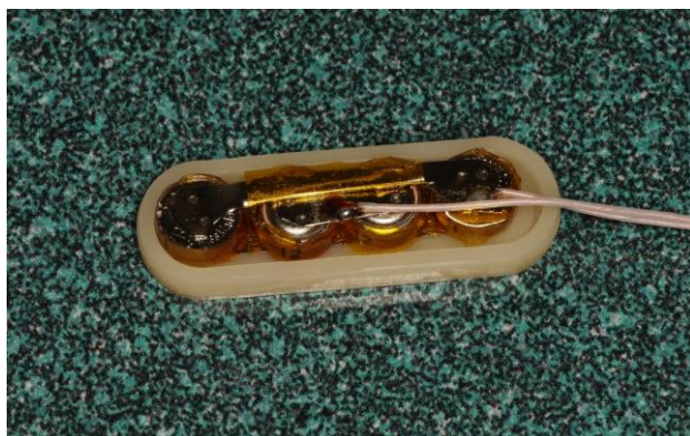
3.13 pav. Pagamintas 3,1 V, 64 mAh baterijų paketas
